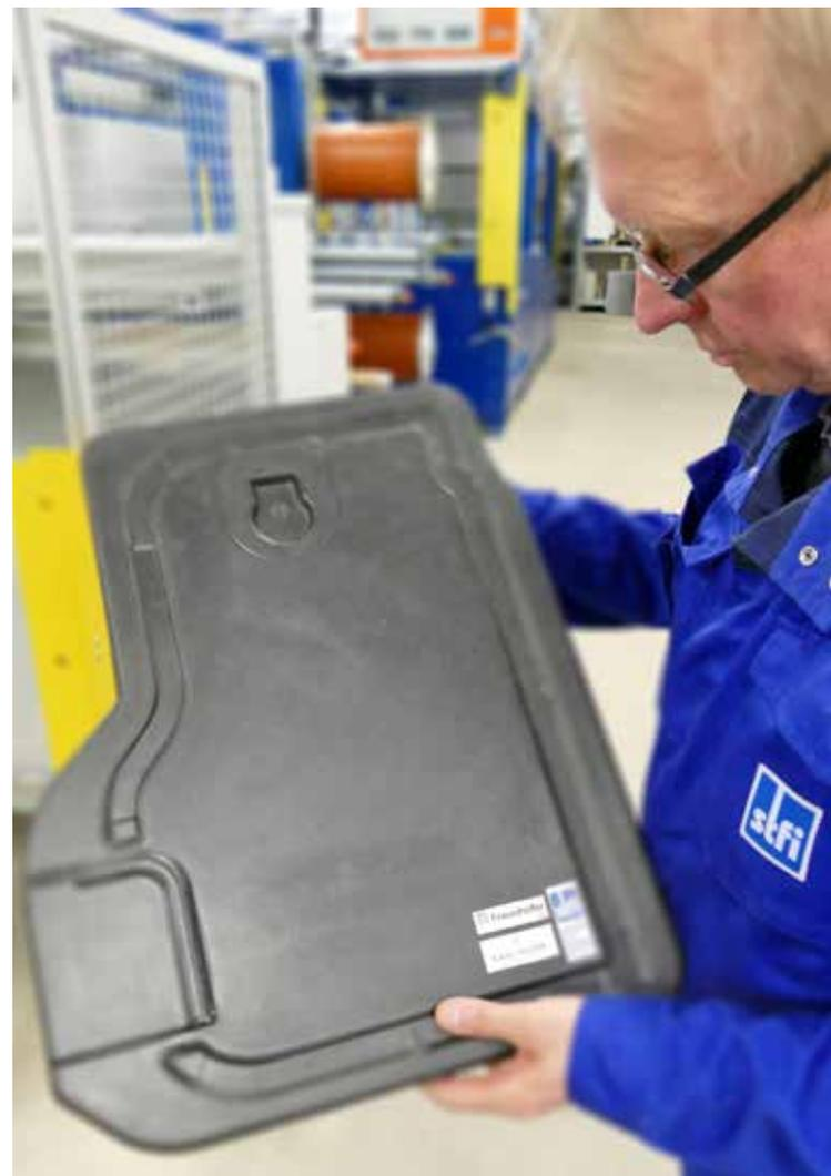
*Im HP-RTM-Verfahren hergestellte hintere Schalenstruktur einer Automobil-Rücksitzbank aus 100 % rCF-Nadelvliesstoff und RTM-Epoxidharz.*
