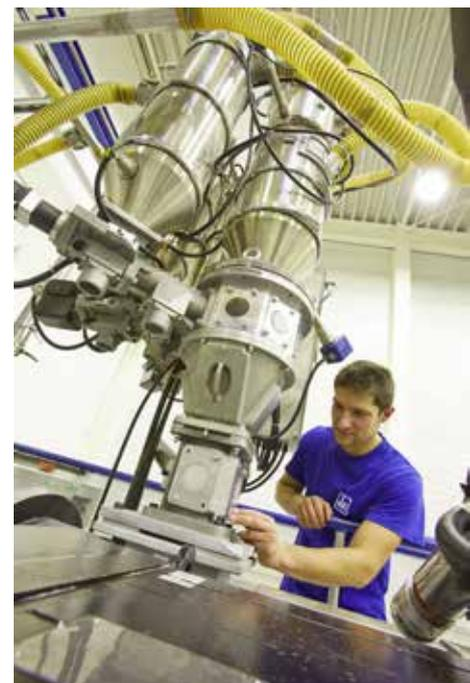
*Techniker Nino Flämig bedient die Dosiereinrichtung für das Granulat an der Spinnvliesanlage.*
