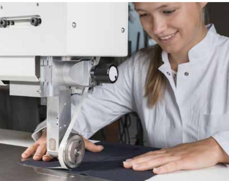
*Ein Bonding-Tape wird zwischen zwei Textilien mit Hilfe einer speziellen Maschinenteknologie aufgebracht.*
