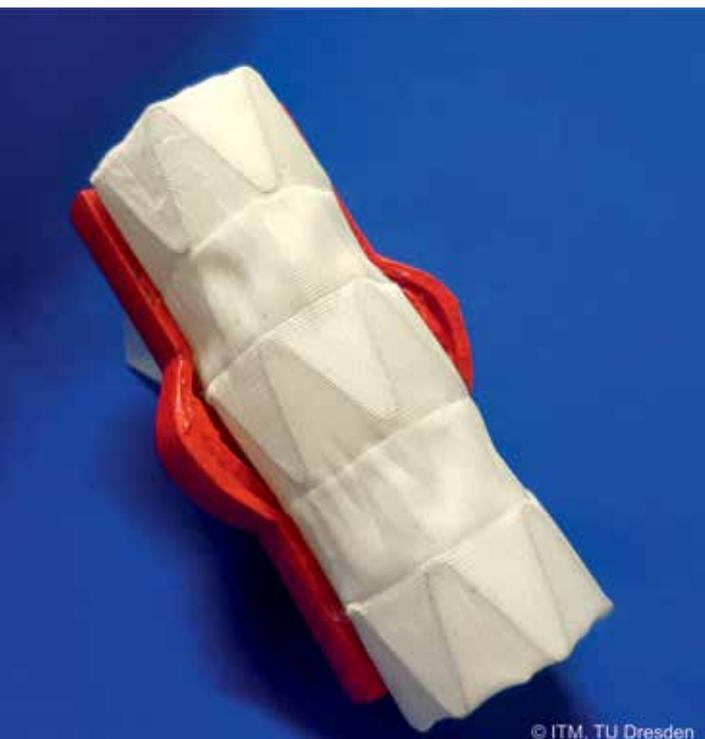
*Integral gefertigte Stentgraft-Gefäßprothese mit integrierten Stentstrukturen (Nitinol-Drähten)*
