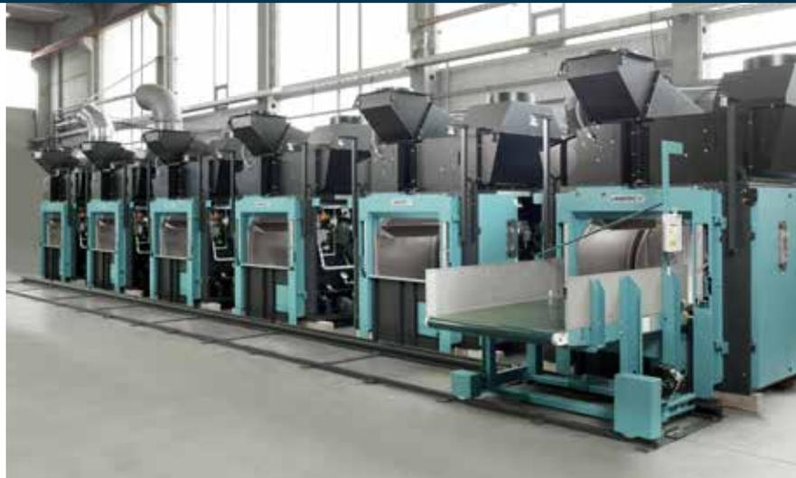
*Lavatec-Trommelrockner mit geregelter Umluftanteil für Energieeinsparung und Textilschonung*
