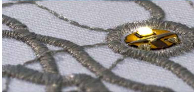
*Eine LED-bestückte Paillette mit leitfähigem Elitex-Garn aufgestickt.*
