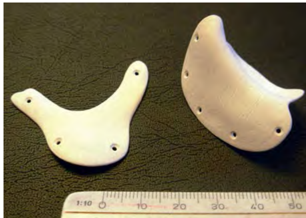
FiberBone: dünnwandige Keramik-Implantate für Augenhöhle und Jochbein
