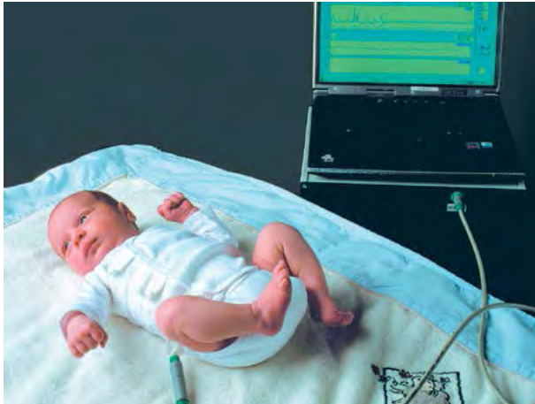
Faserforschung für die Kleinen: Der mit Sensoren ausgestattete Baby-Body des ITV Denkendorf behält auch kleinste Herzen zuverlässig im Blick
