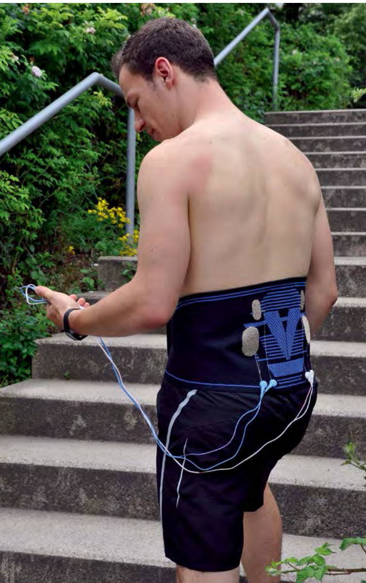
Weich und sensorisch: Ein ITA-Promovend misst mit den moosgestickten Elektroden in der Lumbalbandage seine Vitalfunktionen
