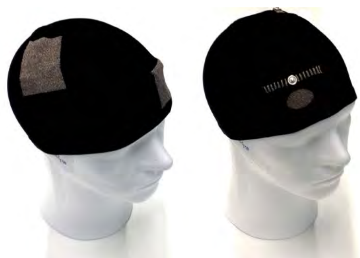
Durch den Schädel: Die textile Haube soll künftig als Therapiehilfe nicht-invasiv die Nerven von Schlaganfallpatienten und Demenzkranken stimulieren
