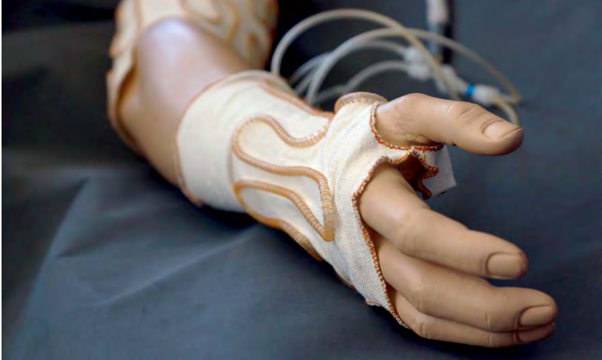
Manschette zum Kühlen und Abschwellen: Innovativ ist der auf das Baumwollgewebe aufgestickte medienführende Schlauch
