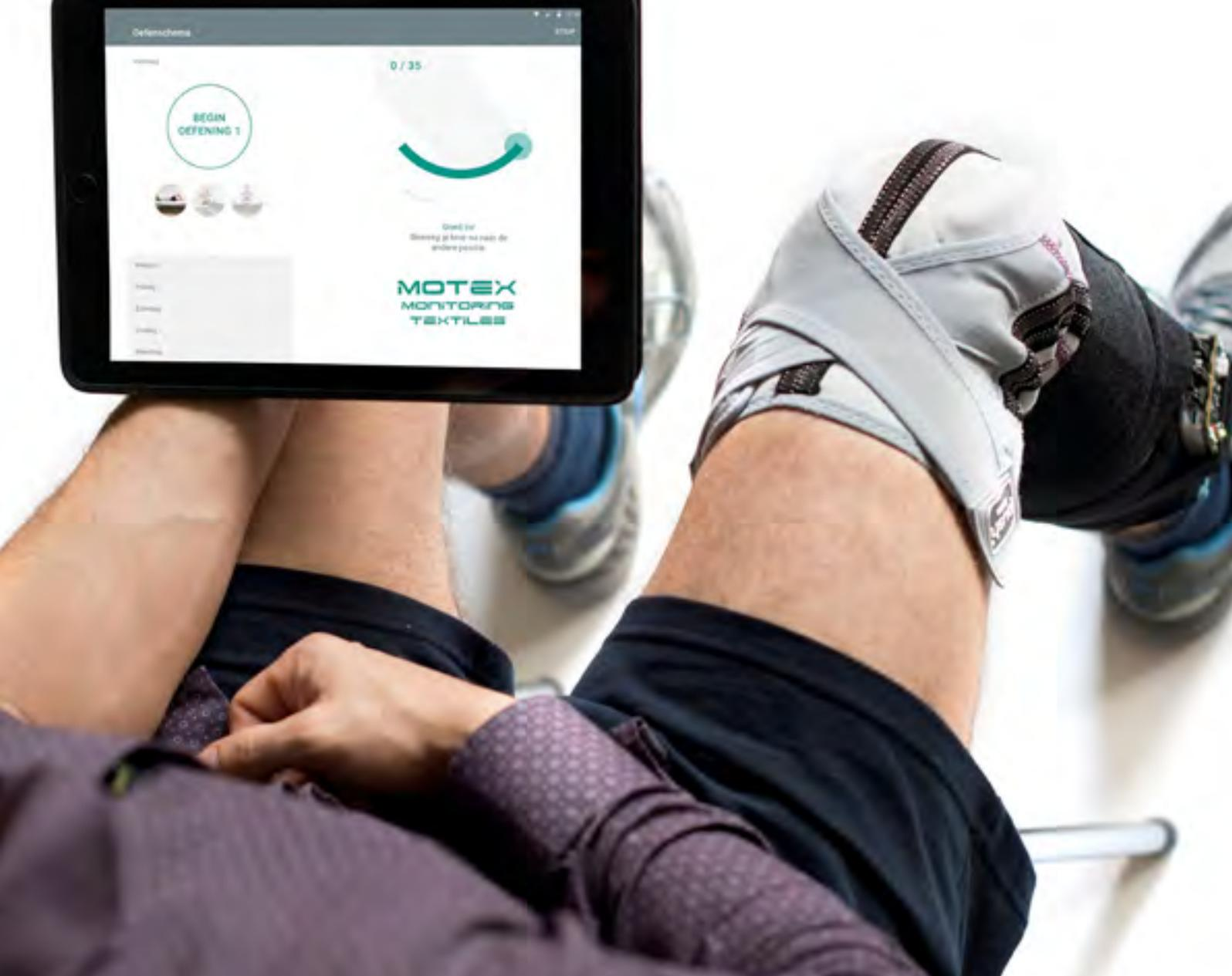
Kniebandage mit Textilsensoren für Reha und Prävention: Im BMWi-geförderten Projekt MOTEX entwickelten Forscher vom Fraunhofer IZM mit Kollegen u. a. vom belgischen Unternehmen Mobilab eine Bandage, die Fehlbelastungen vermeiden soll
