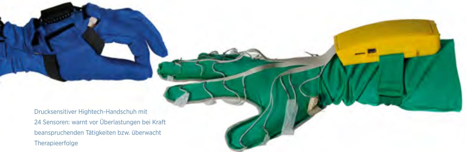
Drucksensitiver Hightech-Handschuh mit 24 Sensoren: warnt vor Überlastungen bei Kraft beanspruchenden Tätigkeiten bzw. überwacht Therapieerfolge
