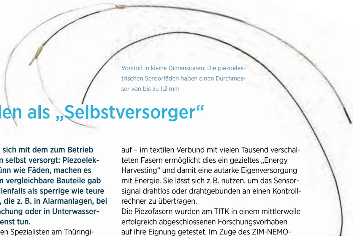
Vorstoß in kleine Dimensionen: Die piezoelektrischen Sensorfäden haben einen Durchmesser von bis zu 1,2 mm
