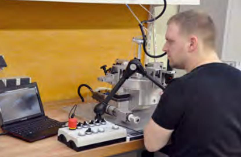
Hightech einfädeln: Textilforscher Kay Ullrich an einem sogenannten Bestückungstisch, an dem leitfähige Fäden mit Bauteilen wie LEDs bestückt werden
