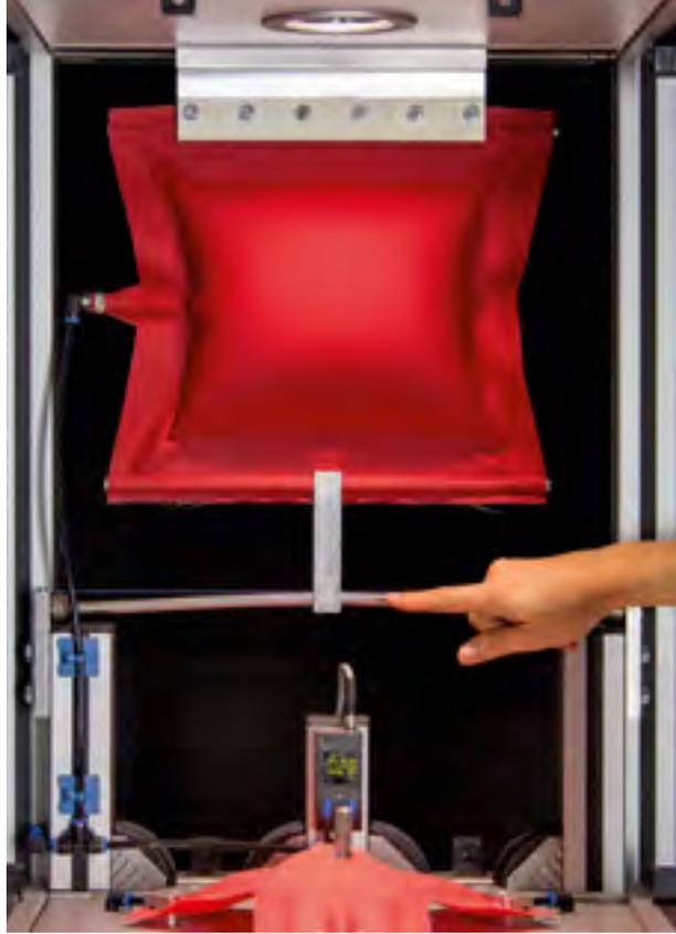
drücken“, fordert Riethmüller so manchen Besucher auf. Keinem gelang bisher, was durch Aufblasen einer nur 20 x 20 x 5 Zentimeter kleinen Textilkammer mit einem Druck von weniger als 0,5 bar möglich wird: Die massive Edelstahlstange wird problemlos verbogen.
