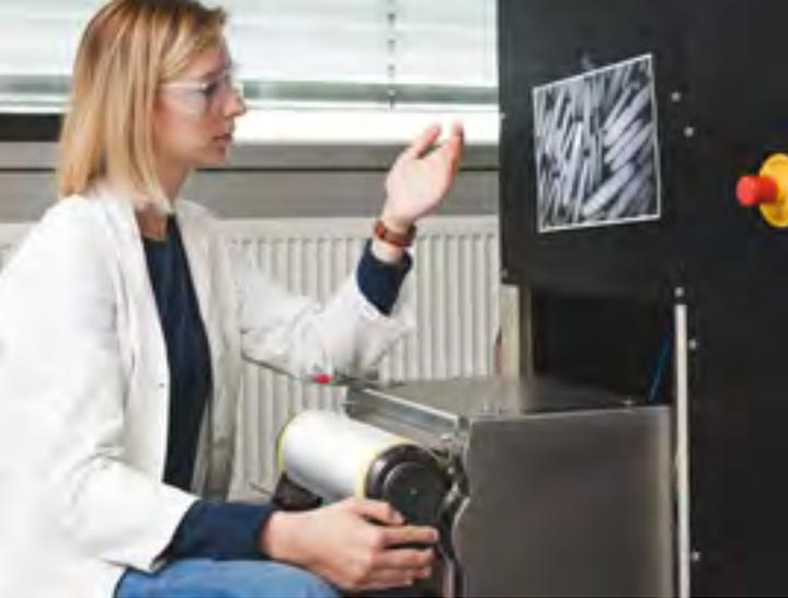
Im Profil: Textilwissenschaftlerin Inga Noll prüft die Qualität eines Filamentgarns im laufenden Prozess
