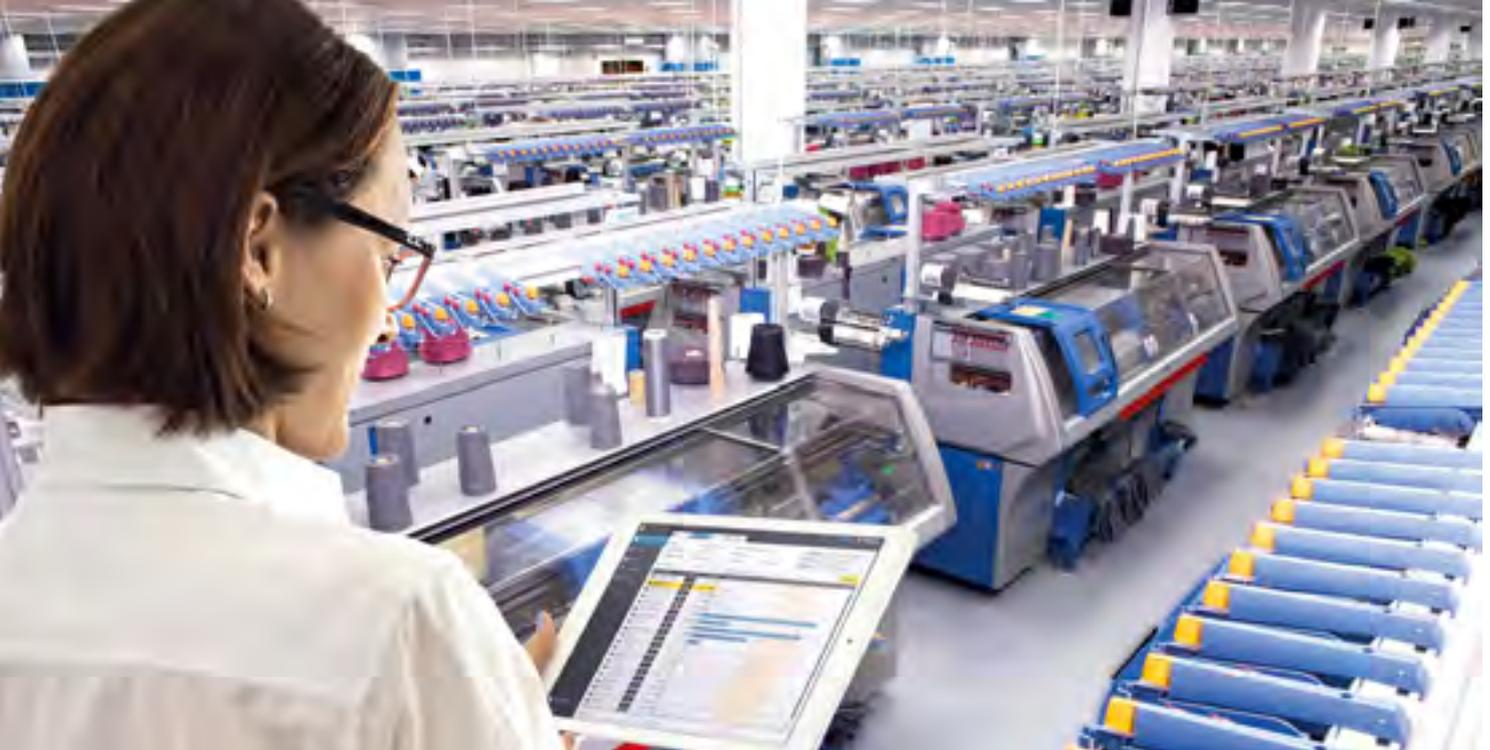
Auf dem Schirm: Mit dem PPS-Softwaretool aus dem Hause Stoll lassen sich bis zu 1.000 Strickerei-Maschinen überwachen und steuern
