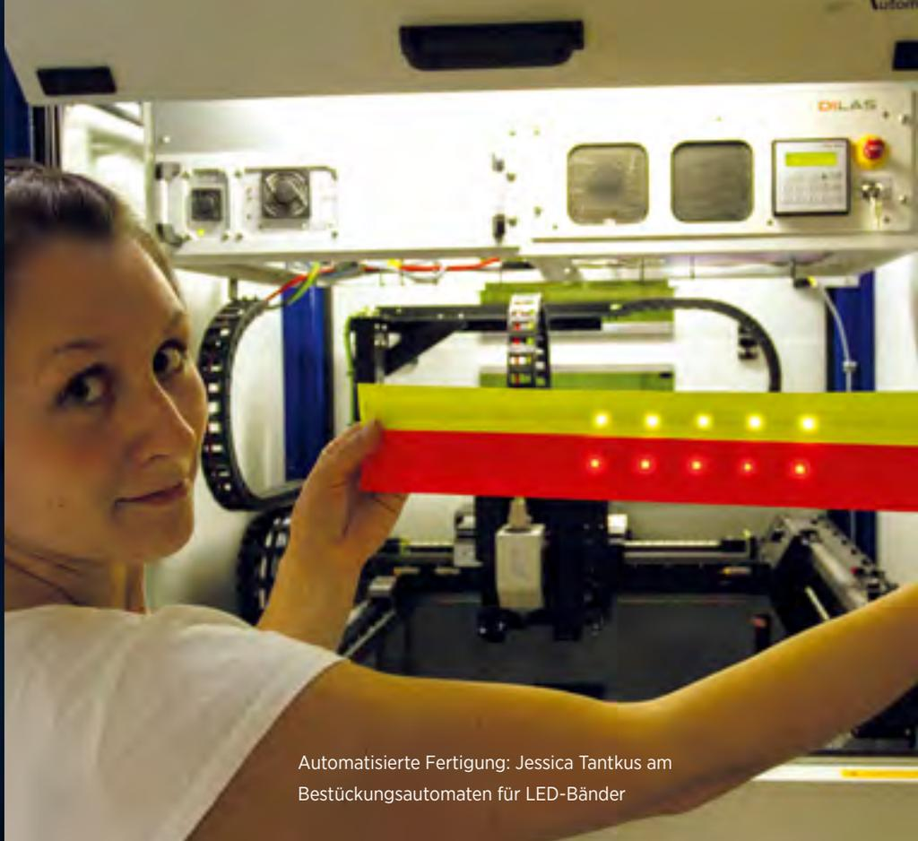
Automatisierte Fertigung: Jessica Tantkus am Bestückungsautomaten für LED-Bänder
