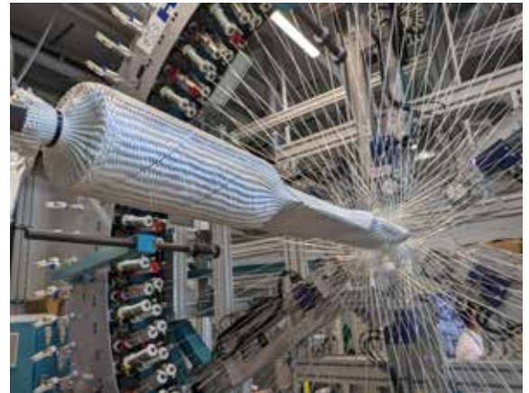
Der FlexiRing im Einsatz: Schläuche mit unterschiedlichen Geometrien werden maschinell und unterbrechungsfrei geflochten.
