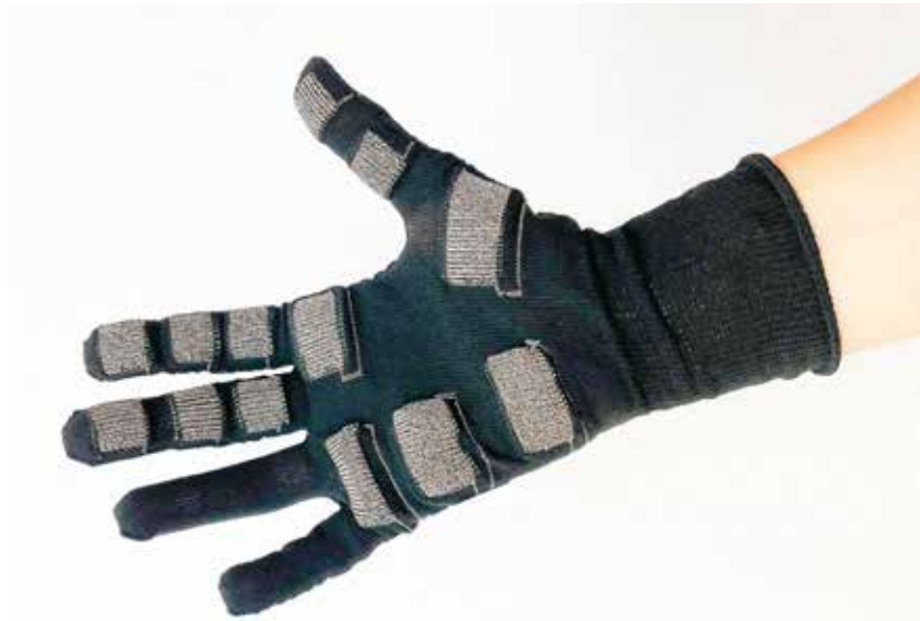
Vollgestrickter Handschuh mit textilbasiertem 3D-Druck-Sensornetzwerk
