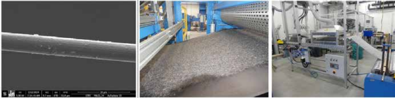
Wiederbeschichtete Carbonfaser, Herstellung von Vliesstoffen aus Carbonfasern, Teststand zur Wiederbeschichtung der Vliesstoffe (v. l. n. r.)
