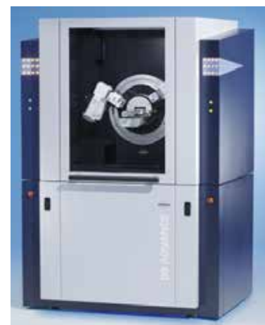
Röntgendiffraktometer zur Charakterisierung von Textilien für das Recycling
