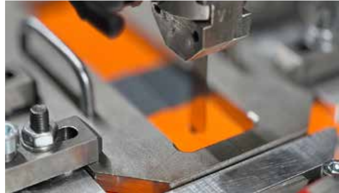
Prüfstand am STFI für Stich- und Schnittprüfung: Einstechen der Prüfklinge
