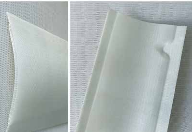
Das thermoplastische Sandwichmaterial lässt sich mit Glasfasern verstärken und komplex umformen.
