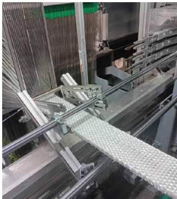
Webversuche zur Herstellung von Mehrlagengeweben für Funktionsmuster
