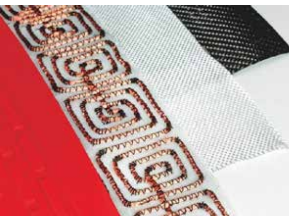
Die Firma msquare stellte während des Anwenderforums eine textile Heizmatte vor, die nach dem Induktionsprinzip funktioniert.
