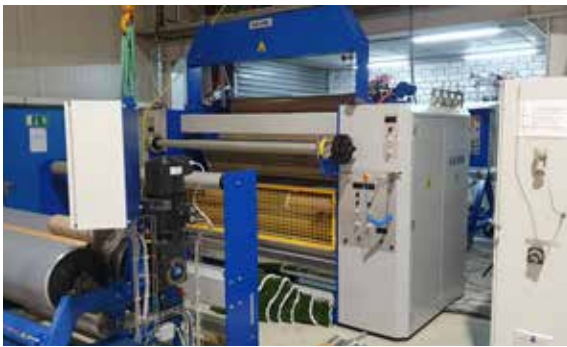
Die neue Thermobondinganlage des TFI
