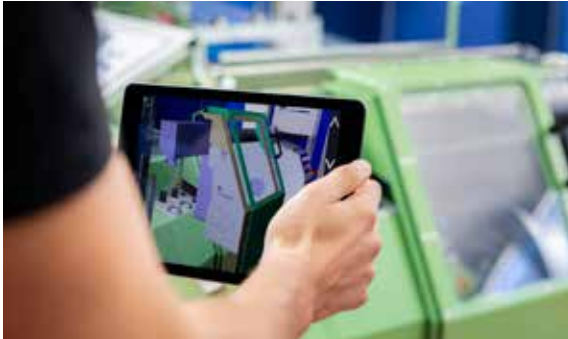
Augmented Reality per Tablet zur Unterstützung von Wartung und Instandhaltung
