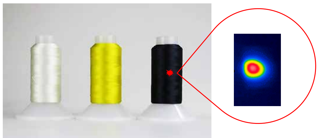
Ein ungefärbtes und zwei mit Dispersionsfarbstoffen gefärbte PET-Markierungsgarne, die 0,05 Gew.-% Lanthanhexaborid-Nanopigmente enthielten, und photothermischer Effekt bei Bestrahlung mit einem NIR-Laser detektiert mit Hilfe einer Wärmebildkamera.
