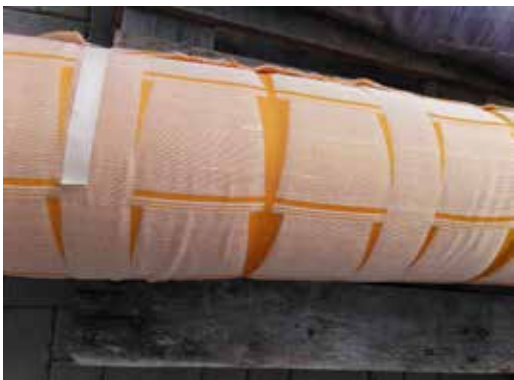
Ein leichtes, bioabbaubares Gewebe mit Pflanztaschen wurde vom Projektpartner F.A. Kreißig & Sohn hergestellt, um damit vertikale Flächen zu begrünen.
