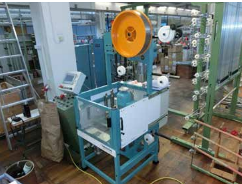
Mit der Seilflechtmaschine vom Typ SENG 1/16-120 mit geteiltem Rumpf der Herzog GmbH ergänzt das STFI sein Portfolio auf diesem Gebiet.
