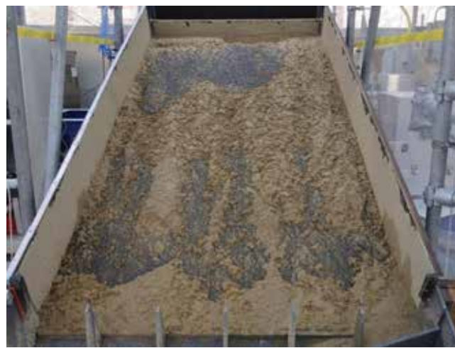
Versuche im Starkregenprüfstand zeigen, dass das getuftete Geotextil (links), den Boden besser zurückhält als das ungetuftete (rechts).
