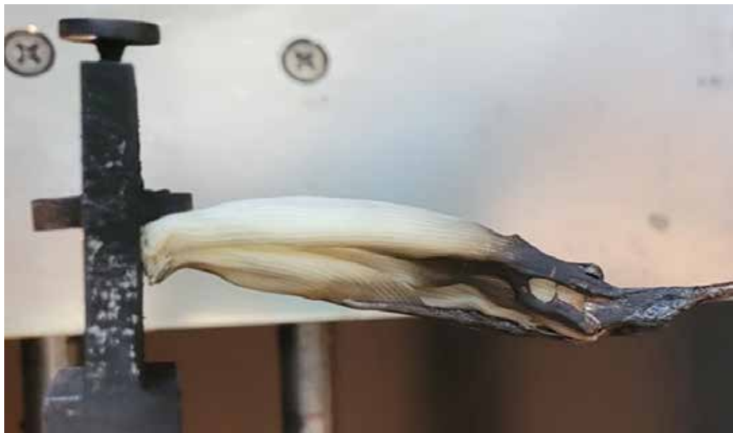
Gestrick aus PA66 additiviert mit 10 Gew-% Poly-DOPO-methacrylat nach Beflammung
