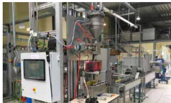
Die Höhe der Spinnereinrichtung flexibel einstellen, den Druck im Filtersystem messen, die Filamente waschen – die neue Filamentspinnanlage in Rudolstadt
