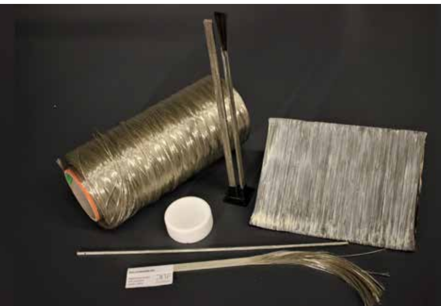
Basaltrovung, CBPC-Matrix, pultrudierte Profile und gewickelte Platte
