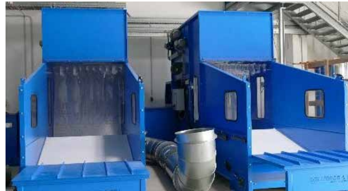
Aufbau der neuen Fasermischanlage für das Technikum Recycling am STFI
