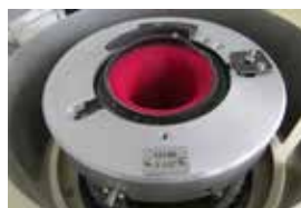
Rundstrickmaschine von Harry Lucas: TK-83 / TK-83-L, 1 System, gg/E 24, Durchmesser 3 ½ inch
