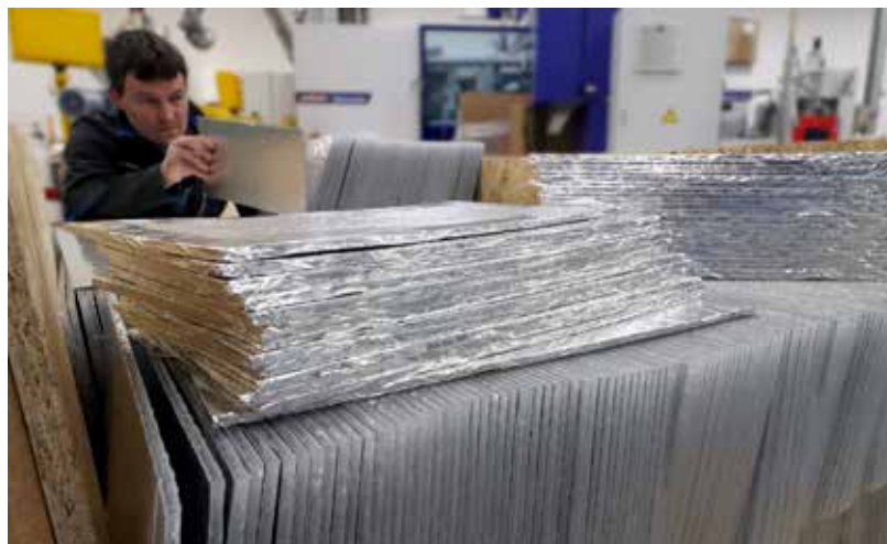
PCM-Verbundplatten, hergestellt von der Firma smartpolymer in Rudolstadt, zur Absicherung der Kühlkette bei Impfstoff-, Blut- oder anderen medizinischen Transporten.
