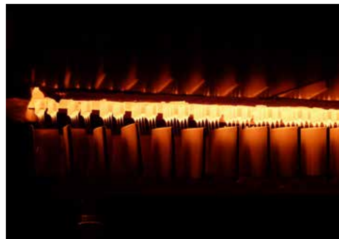
Die Spinnentechnologie ermöglicht die Beschichtung jeder einzelnen Faser (Einzelfilamentbeschichtung) im Herstellungsprozess von Hochleistungs-Verbundfasern.
