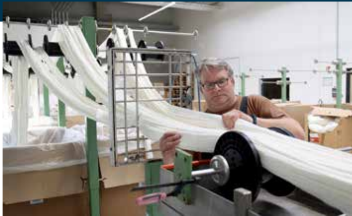
Holger Müller von der Firma smartpolymer in Rudolstadt richtet den Faserstrang aus, während er die Schneidmaschinen neu bestückt.
