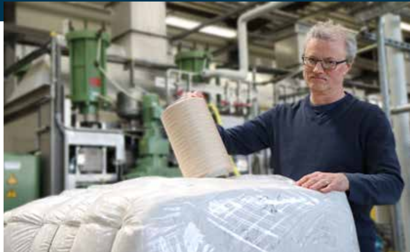
Dr. Frank Wendler mit der antibakteriellen Faser Cell Solution® bioactive – einmal eine Spule mit einem Endlosfaden, darunter versandfertig verpackte Stapelfasern.
