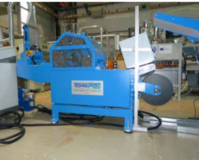
Die neue Labor-Vliesstofflinie hat eine Arbeitsbreite von nur 30 Zentimetern.
