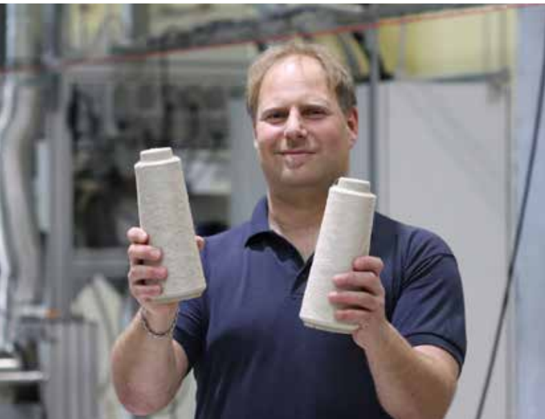
Anlagenfahrer Roberto Köhler vom TITK Rudolstadt zeigt zwei Spulen mit Garnen unterschiedlicher Feinheit, hergestellt aus einer hanfbasierten Lyocell-Faser der neuen Marke Lyohemp®.
