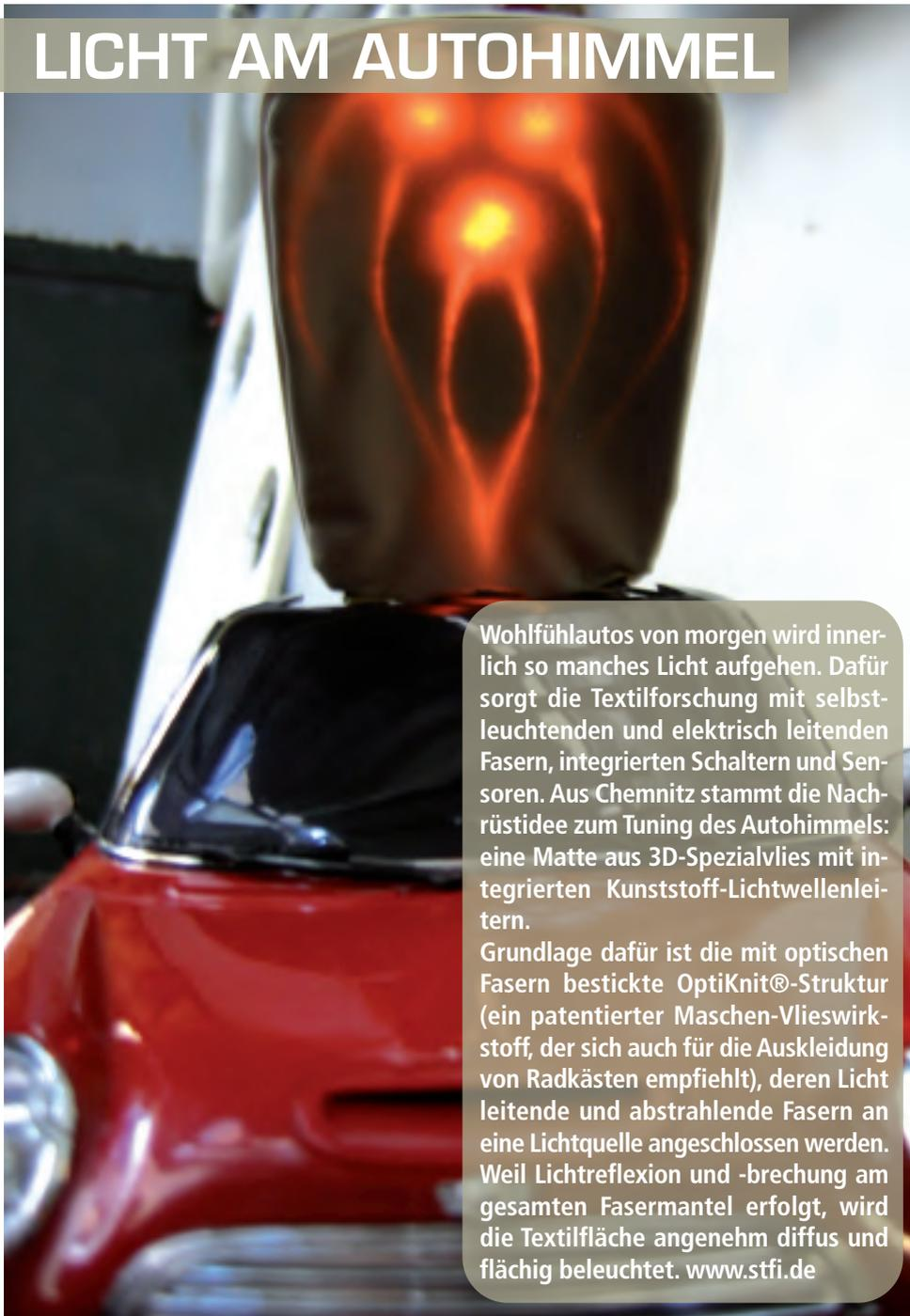
Wohlfühlautos von morgen wird innerlich so manches Licht aufgehen. Dafür sorgt die Textilforschung mit selbstleuchtenden und elektrisch leitenden Fasern, integrierten Schaltern und Sensoren. Aus Chemnitz stammt die Nachrüstidee zum Tuning des Autohimmels: eine Matte aus 3D-Spezialvlies mit integrierten Kunststoff-Lichtwellenleitern.
